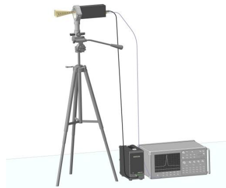
Рис. 4 Антенна П6-133 с преобразователем частоты СК5РТ 40-50,50-60/3-18 WR19
